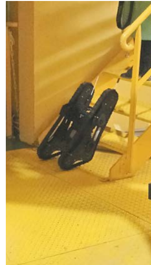
Nerva, après avoir réalisé un point de mesure dans un escalier de pente → 40 %
