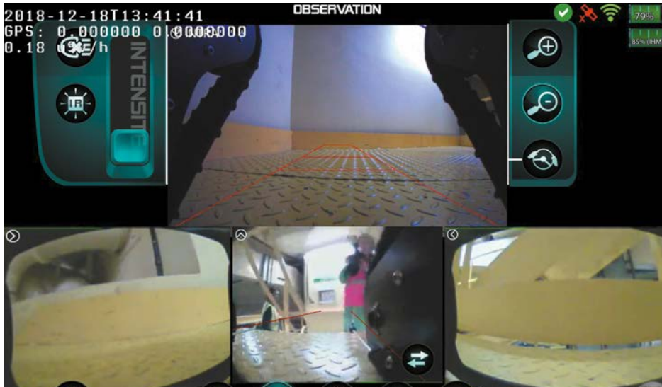
Les 4 caméras de Nerva en action, et retour d'information du niveau d'irradiation
